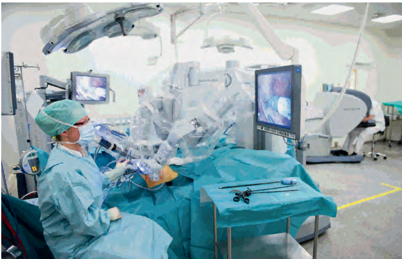
På taburetten ved patienten er lægen skiftet ud med operationssygeplejerske Jane Petersson, som har overtaget assistentfunktionen ved nogle robotoperationer. Kirurgen styrer robotens instrumenter fra en konsol nogle meter derfra.
